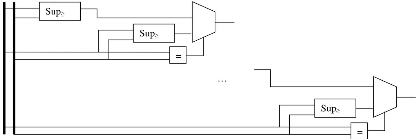
**Q3.** Circuit séquentiel de comparaison. Il s'agit de boucler la couche répétée 31 fois de la question 2 avec 1 registre 1 bit pour le résultat courant, et 2 registres 32 bits pour A et B pour lesquels dans la boucle il y a un décaleurs de telle sorte que l'entrée de la couche prenne toujours en entrée  $A_0$  et  $B_0$  mais que, avec les décaleurs,  $A_0$  et  $B_0$  soient au  $i^{\text{ème}}$  top d'horloge les valeurs  $A_i$  et  $B_i$  des A et B initiaux.
